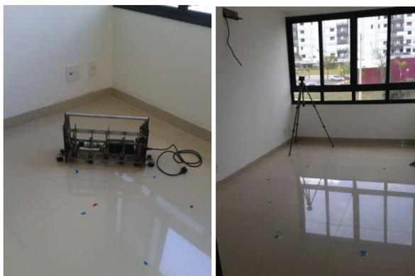
**Figura 2:** Equipamentos utilizados (esq.: MIP na sala emissora. Dir.: microfone posicionado na sala receptora).
